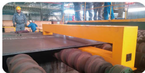
● 某钢厂大型钢板退磁
